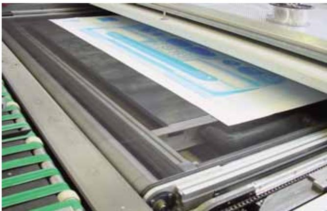
„Höchste Produktionskapazität bei minimalem Personaleinsatz“ lautete das Ziel bei der Konstruktion der Siebdruckmaschine THIEME 5000 XL. Hierbei erwies sich das bis zu 2000 x 3050 mm große Druckformat als besondere Herausforderung. Bisher verwendete Komponenten, wie der zentrale Antrieb und die Königswelle, waren für dieses Format zu groß, um sie sinnvoll in das bestehende Maschinenkonzept zu integrieren.
